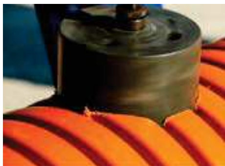
1 Utilizzare un trapano a punta circolare 1 Use a drill with a circular bit
