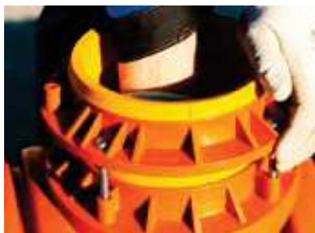
7 Applicazione colla per codolo 7 Application of glue
